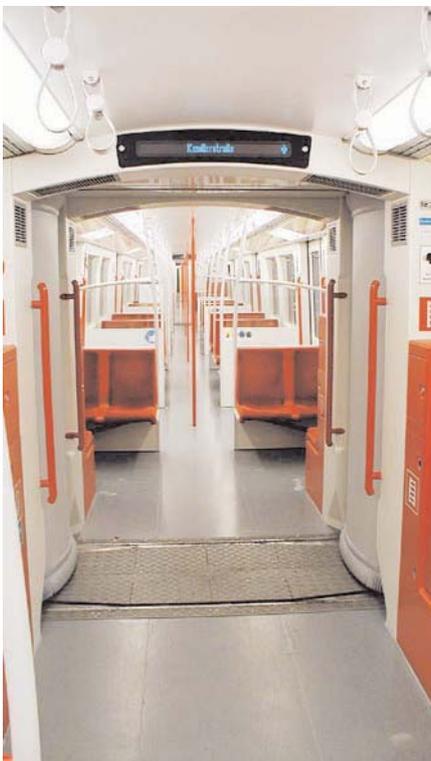
Beim neuen U-Bahn-Wagen gibt es keine getrennten Wagen mehr. Grundeinheit des neuen technischen Konzeptes ist ein durchgehend benutzbares Fahrzeug von run 112 Metern Länge.
