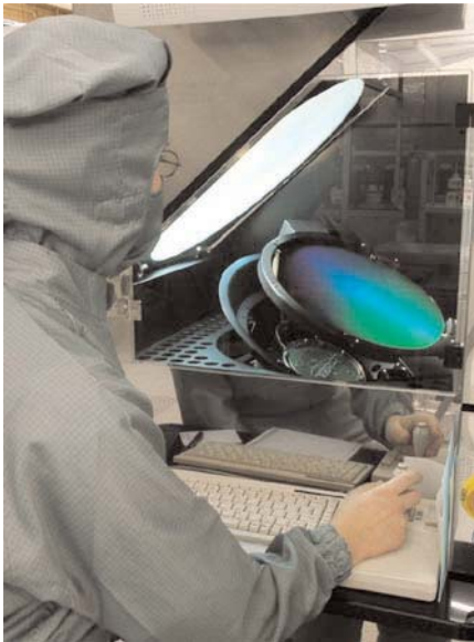
Dieses Bild zeigt die optische Kontrolle der Waferoberfläche unter Schräglicht in der 300-mm-Meßtechnik
