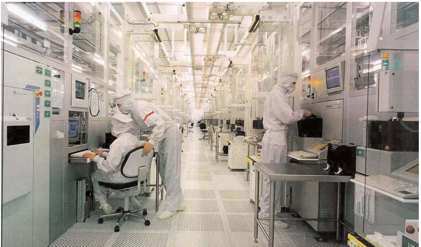
Die Aufnahme zeigt den Blick in einen Produktionsfinger der 200-mm-Linie. Links im Bild Sputteranlagen zur Erzeugung metallischer Schichten auf dem Wafer, rechts Anlagen zur Veraschung von Fotolackrückständen
