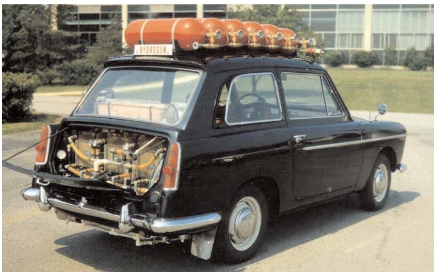
Oben: das erste mit Brennstoffzellen betriebene Motorrad des Grazer Pioniers Karl Kordesch. Unten: einer der Versuche, hier mit einem Austin
