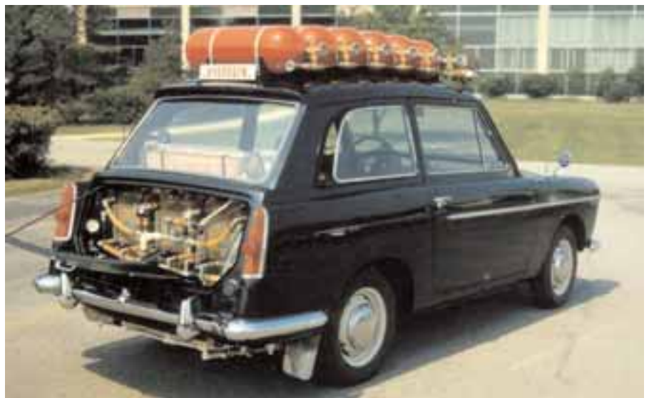
Oben: das erste mit Brennstoffzellen betriebene Motorrad des Grazer Pioniers Karl Kordesch. Unten: einer der Versuche, hier mit einem Austin
