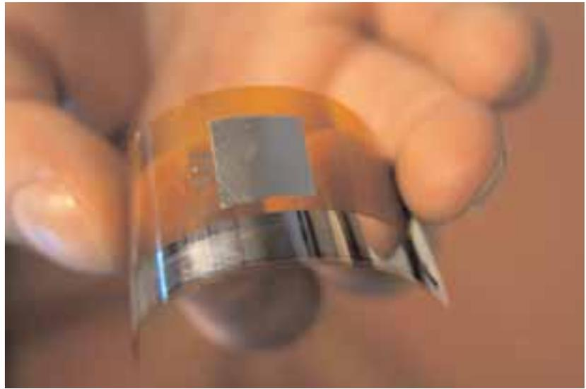
Greifbare Forschungsergebnisse: Ferroelectret Field-Effect Transistor auf einer flexiblen Folie
