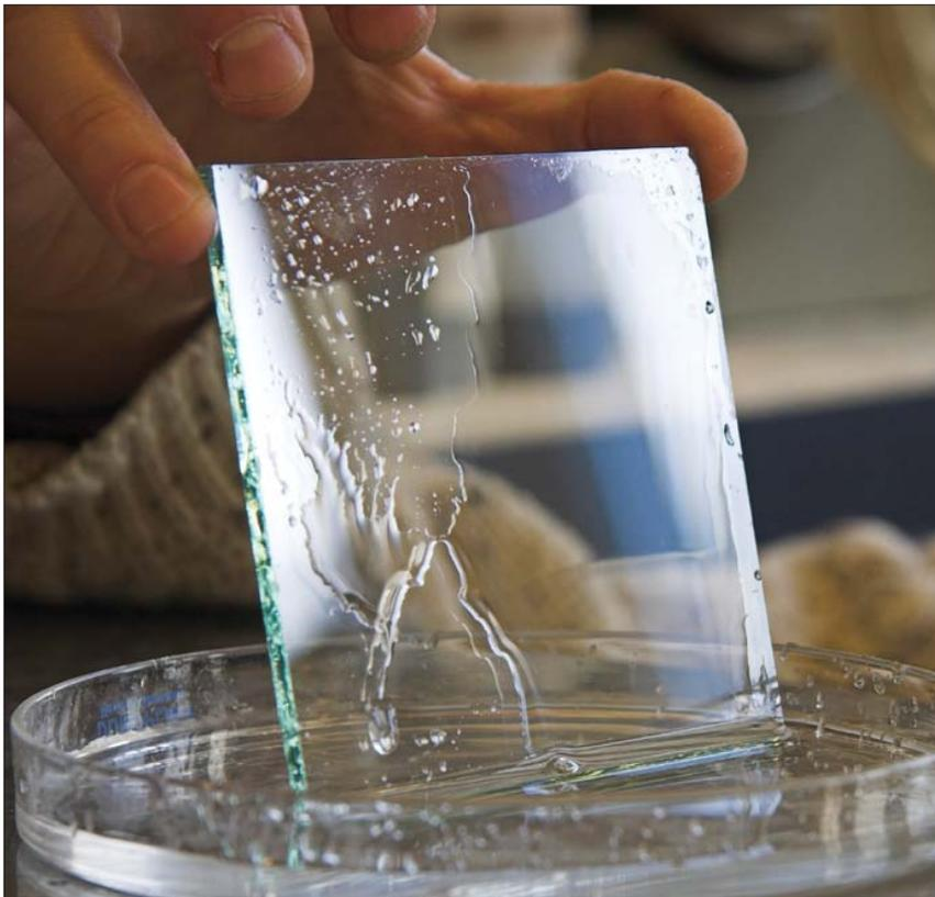
Man sieht man eine mit TiO<sub>2</sub> beschichtete Glasscheibe (kommerziell erhältliches Pilkington Activ), deren rechte Hälfte einige Minuten mit UVA-Licht bestrahlt worden war (die linke Hälfte war abgedunkelt). Dadurch kommt es auf der rechten Seite zu einem glatt ablaufenden Wasserfilm, wohingegen links eindeutige Tropfenbildung zu erkennen ist.
