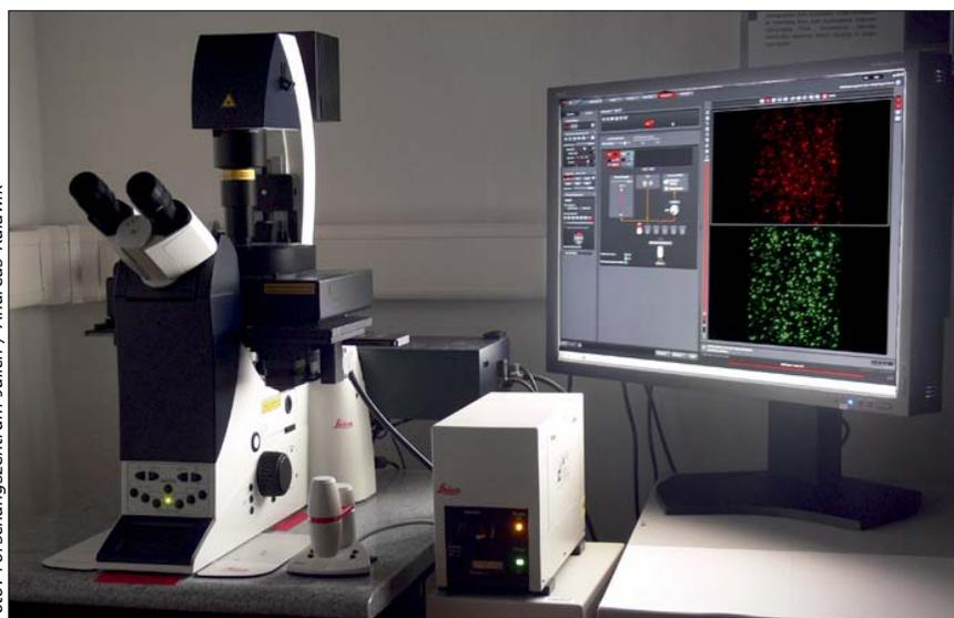
Unter dem Fluoreszenzmikroskop werden die Oligomere sichtbar.
