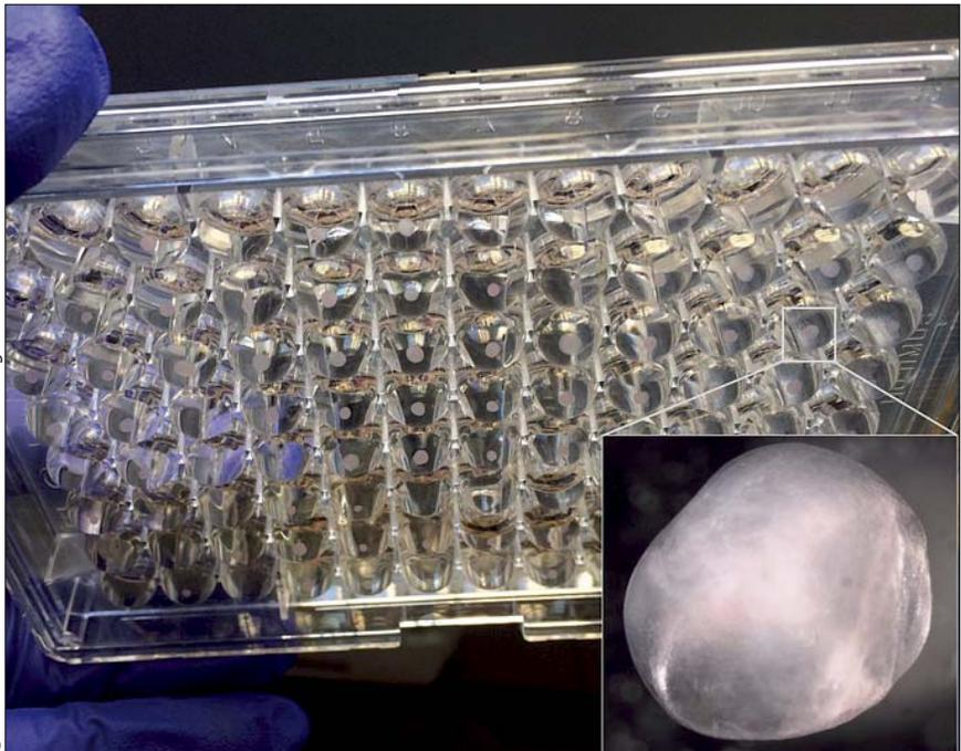
Gefäßorganoide für Drogentests: Gefäßorganoide werden in einem Miniaturformat hergestellt, das im Labor die Durchmusterung von Humanblutgefäßen mit hohem Durchsatz ermöglicht.
