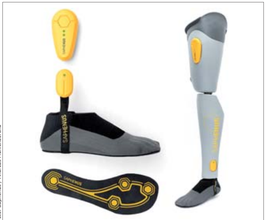
Sensorisches Feedbacksystem und Bild einer Applizierung an einer Beinprothese (Oberschenkelamputation)
