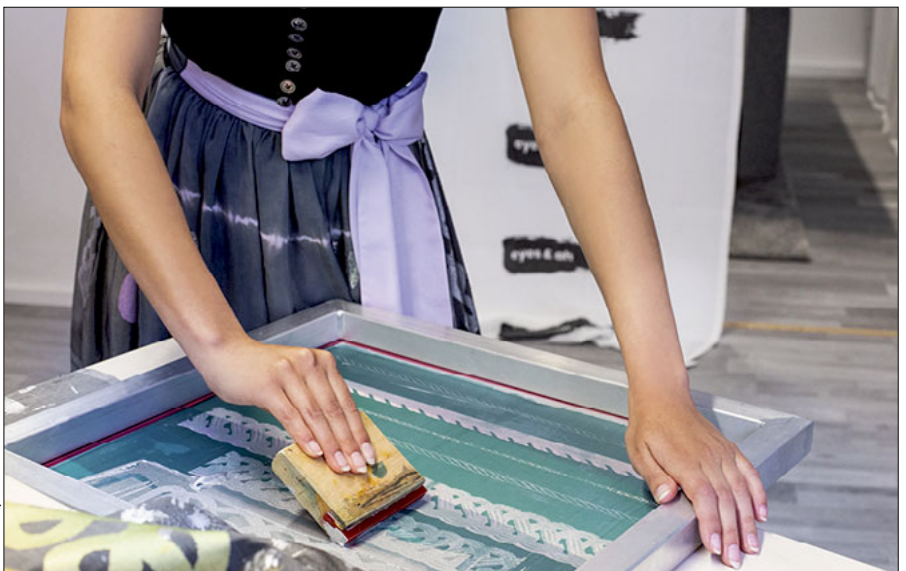
Mit Siebdruck werden die Ornamente, die dem Flechtmuster aus dem Stift Millstatt nachempfunden sind, auf den Stoff aufgebracht.
