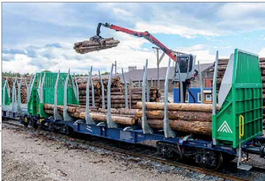
GigaWood-Waggons mit doppelter Ladekapazität
