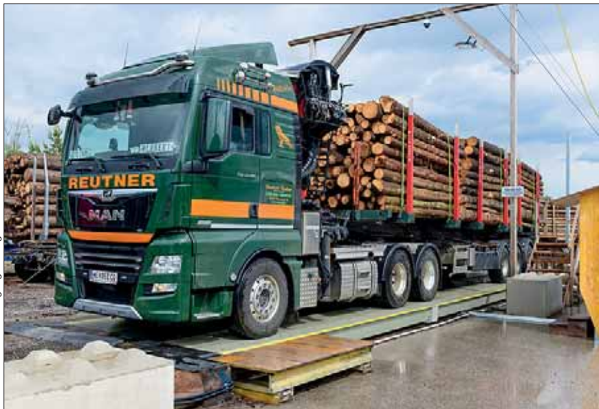
Mobile Brückenwaage - vollautomatische Verwiegung des Ladegutes
