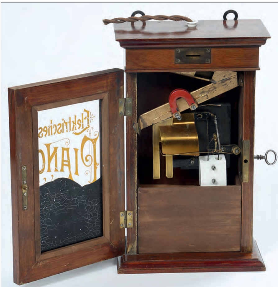
Münzprüfer für ein elektrisches Piano, um 1910
