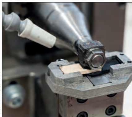
Beim Ultraschallfügen verbinden sich Holz und Grundbauteil durch Reibungshitze
